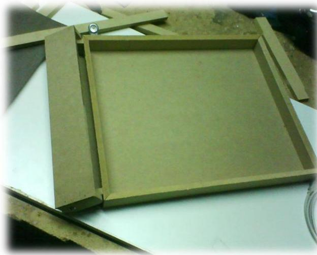
Se elaboró también otro marco en la parte interna, con el fin de dejar un pequeño espacio para colocar todo el cableado de los componentes electrónicos y las extensiones.
