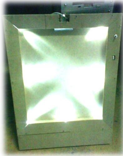
Se pulieron los bordes y se colocaron las pestañas en la parte posterior para que encajara con el visor acrílico que servirá como soporte de la tabla de dibujo.
