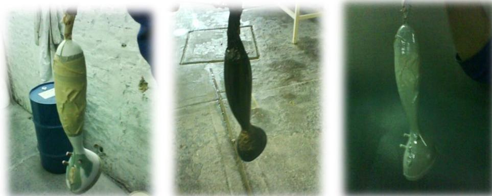
Se retira la cinta y se lija la pintura para perfeccionar los acabado y se procede a probar el funcionamiento del producto, junto con los otros elementos del kit.
