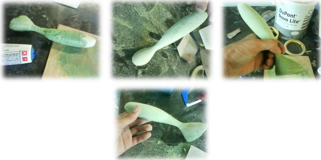
A continuacion, se procedio a elaborar un molde para fabricar el prototipo en un material resistente, que en este caso es la fibra de vidrio, por lo tanto se genero un soporte en madera para elaborar la primera mitad del molde bipartido que permitiria sacar la pieza rigida mas adelante.
