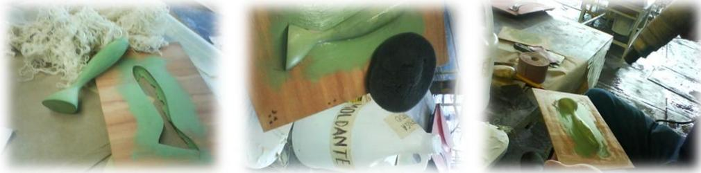
Se ubicaron unas piezas guia y se aplico gelco Rojo y fibra de vidrio con resina poliester para fabricar la primera cara del molde.
