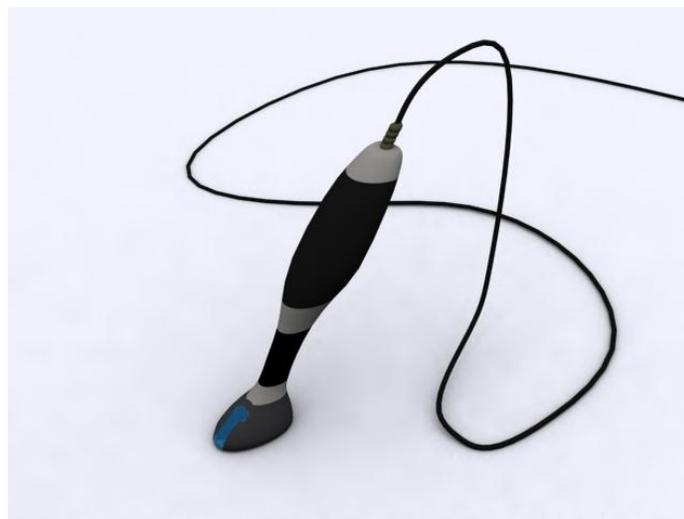
Se diseñó la forma de donde se sujeta el dispositivo, de una manera delgada, con el fin de que guardara similitud con otros instrumentos como lápices, lapiceros, y marcadores, se extendieron todos los mecanismos de la tarjeta del mouse por medio de delgados cables, con el fin de poder hacer la parte de la sujeción más delgada, y comprimir lo máximo posible la parte inferior del dispositivo, donde se encuentran la mayoría de mecanismos.
