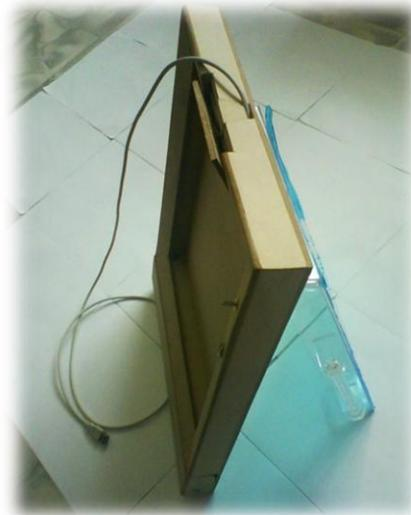
Se le aplicó sellante a la madera con el fin de que el elemento fuera un poco más resistente y como detalle final se le colocaron unos trozos de tapiz, que se encargaron de darle un toque más estético a la herramienta, y de esta forma se concluyó con el proceso productivo de este otro elemento del kit de aprendizaje, el siguiente y último elemento a analizar en este proceso productivo será la herramienta de ejercicios virtuales o lápiz óptico, que será descrito a continuación.
