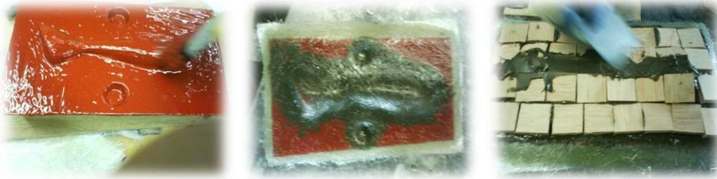
Se le coloco estructura en madera y masilla para evitar que se pandeára el molde, despues de secar, se desmoldéo, y se retiró el modelo interno de poliuretano
