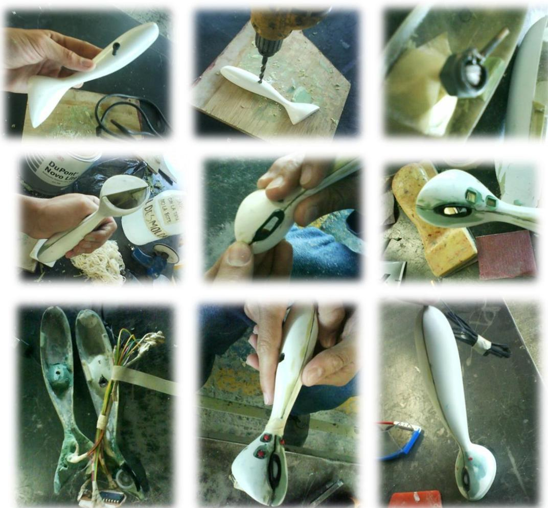
Luego de tener todos los elementos en el lugar correcto y completamente funcionando, se continua con el proceso de pintura, para darle el acabo final al producto.
